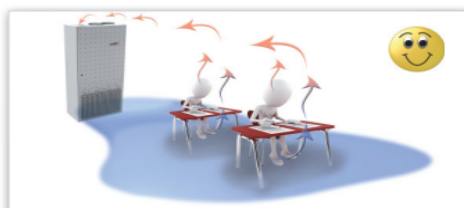
Quelllüftung (Turbulenzarme Verdrängungslüftung)
