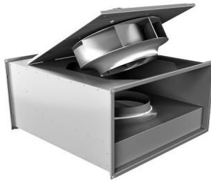
Gehäuse aus verzinktem Stahlblech als rechteckiger Kanal ausgebildet zum direkten Einbau in Luftkanäle. Saug- und druckseitig mit 20 mm breiten Normflanschen. Montage mit horizontaler oder vertikaler Motorwelle. Einseitig saugendes Laufrad aus Aluminium (AlMg3) mit 8 rückwärtsgekrümmten Schaufeln und ausschwenkbarer Motorlaufradeinheit. Spannungssteuerbarer AC-Außenläufermotor. Wartungsfreie, beidseitig geschlossene Lagerung mit Langzeitschmierung. Standardausführung mit Kabel seitlich.
