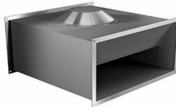
Gehäuse aus verzinktem Stahlblech als rechteckiger Kanal ausgebildet zum direkten Einbau in Luftkanäle. Saug- und druckseitig mit 20 mm breiten Normflanschen. Montage mit horizontaler oder vertikaler Motorwelle. Einseitig saugendes Laufrad aus verzinktem Stahlblech mit vorwärtsgekrümmten Schaufeln. Aufgrund der hohen Schaufelanzahl ergibt sich ein geräuschoptimiertes und zugleich kompaktes Design.
