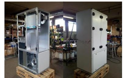
Gehäuse für Spezialwärmepumpe, mit zusätzlicher Belüftung. Gehäuse vorbereitet für Endmontage bei Kunde. Option: Gehäuse teilmontiert bei Bonotec – Endmontage bei Kunde. →
