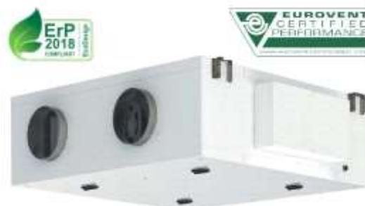
Kompaktgeräte mit integrierter Steuerung sind in 7 Grössen mit Nennluftdurchsätzen von 650m<sup>3</sup>/h bis 4000m<sup>3</sup>/h erhältlich und sind in den Versionen ECO, PLUS und TOP erhältlich. Dichtheitsklasse L1, Gehäuseklasse T2/TB2 gemäss EN1886. In Horizontal- und Deckenmontage erhältlich.
