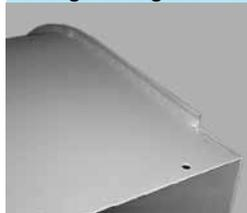
Um Spaltkorrosion bei Förderung feuchter oder leicht aggressiver Medien zu verhindern können die Gehäuse durchgehend geschweißt werden. Mit der "Durchschweißung" wird eine relative Dichtheit des Gehäuses erreicht.
