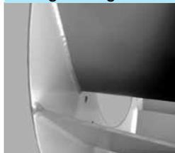
Um Spaltkorrosion bei Förderung feuchter oder leicht aggressiver Medien zu verhindern können die Laufradschaufeln durchgehend geschweißt werden. Die "Durchschweißung" hat keinen Einfluss auf die Festigkeit bzw. die zul. Umfangsgeschwindigkeit des Laufrades.
