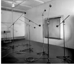
Die Geräuschmessung und -auswertung erfolgte nach DIN 45635-38. „Geräuschmessung an Maschinen; Ventilatoren“.
