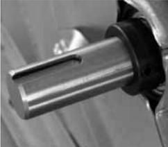
Die Wellen sind aus geschliffenem, kohlenstoffhaltigem Präzisions-Rundstahl C40 hergestellt. Sie sind vorwiegend durchgehend ohne Wellenansatz ausgeführt. Die Wellen der Baureihen RDH K1 und K2, Baugröße 1000 sind an beiden Enden zur Aufnahme der Riemenscheibe abgesetzt.
