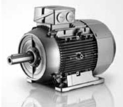
Es werden Normmotoren bekannter Markenfabrikate, Schutzart IP55, Wärmeklasse F verwendet. Bei Inbetriebnahme und Wartung sind die detaillierten Angaben des Motorherstellers (Typenschild / Betriebsanleitung - Motor) zu beachten, dies gilt auch für bauseits vorzusehende Motorschutzeinrichtungen. Die Motoren sind standardmäßig mit Kaltleiter-Temperaturfühlern ausgerüstet. Motoren mit integriertem Frequenzumrichter auf Anfrage.
