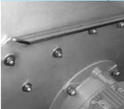
Für Anwendungen mit erhöhter Korrosionsbeanspruchung können die Verbindungselemente des Ventilators aus Edelstahl gewählt werden.
