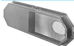
Der Riemenschutz ist standardmäßig aus verzinktem Stahlblech gefertigt und allseitig geschlossen (entsprechend DIN EN ISO 13857). Für Inspektionszwecke kann das Vorderteil gelöst und abgenommen werden.
