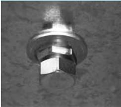
Wird der Ventilator im Freien aufgestellt, oder fördert er feuchtes Medium, kann sich im Ventilatorgehäuse Kondenswasser ansammeln. Zur Ableitung des Kondenswassers muss ein Ablaufstutzen an der tiefsten Stelle des Gehäuses angebracht werden. Dieser besitzt zum Anschluss eines Ablaufrohres ein Rohrgewinde. Bei Bestellung ist unbedingt die Gehäusestellung anzugeben!
