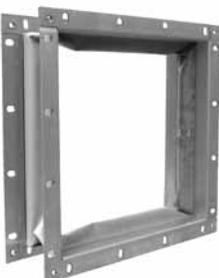
Anschlussstutzen mit elastischem Zwischenstück zum schwingungs- bzw. körper-schall entkoppelten Anschluss des Ventilators an Anlage oder Gerät. Gefertigt aus zwei Anschlussflanschen mit elastischem Zwischenstück.
