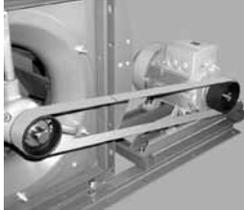
Die zum Einsatz kommenden Flachriemen werden unter Verwendung modernster Technologien und Materialien gefertigt. Sie bilden das Kernstück für einen hoch entwickelten, leistungsfähigen Riementrieb. Dieser moderne Flachriementrieb hat gegenüber dem traditionell verwendeten Keilriementrieb wesentliche Vorteile und übertrifft diesen in Effizienz, Laufruhe und Wirtschaftlichkeit.
