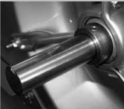
Die Wellen werden aus geschältem und poliertem, kohlenstoffhaltigem Präzisions-Rundstahl C35 hergestellt. Sie sind bis einschließlich Baugröße 1000 ohne Wellenbund. Bei den Baugrößen 1120/-1600 sind die Wellen an beiden Seiten zur Aufnahme der Riemenscheibe abgesetzt.
