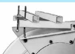
Die Motorwippe ermöglicht eine Befestigung des Motors direkt am Gehäuse, wenn nur ein begrenzter Raum zur Verfügung steht. Eine Seite der Wippe ist im Ventilatorgehäuse drehbar befestigt, während die andere Seite über eine verstellbare Spindel abgestützt wird, so dass sich ein ausreichender Spannweg für die Keilriemen ergibt. Die möglichen Motoranordnungen und Gehäusestellungen sind den Maßbildern zu entnehmen. In den Maßstabellen sind außerdem die max. zulässigen Motorbaugrößen angegeben.
